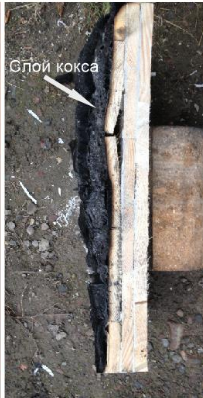
Рисунок 45.- Состояние клеёной пространственной деревянной конструкции: а) до испытаний, б) во время огневого воздействия, в) после 30 мин. огневого воздействия
