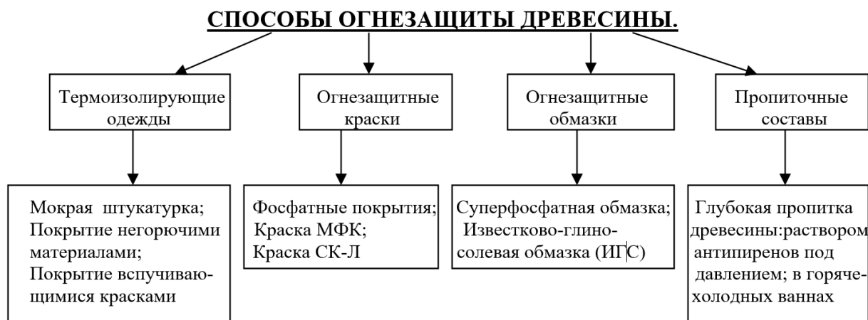
Рисунок 30 - Схема огнезащиты
