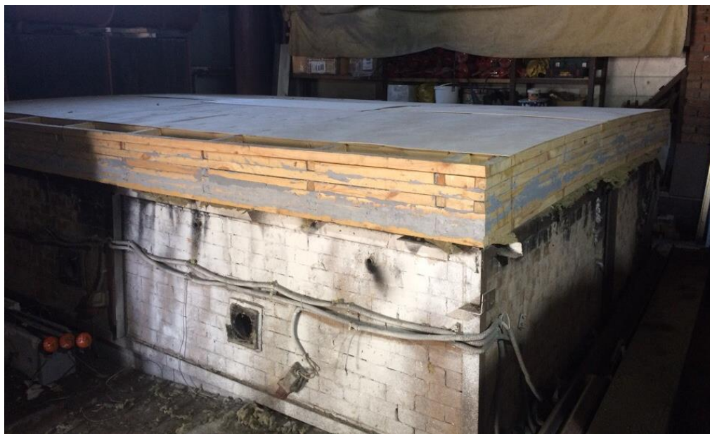
Рисунок48 - Огневые испытания пространственной сетчатой деревянной конструкции
