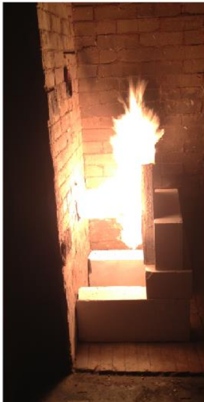
Рисунок 45.- Состояние клеёной пространственной деревянной конструкции: а) до испытаний, б) во время огневого воздействия, в) после 30 мин. огневого воздействия
