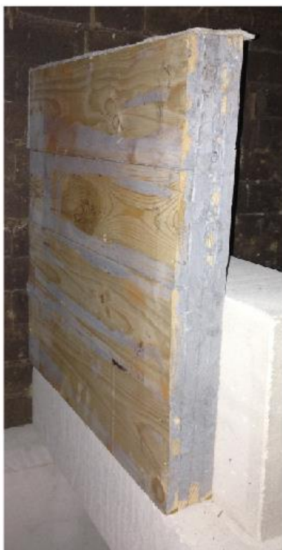
Рисунок 45.- Состояние клеёной пространственной деревянной конструкции: а) до испытаний, б) во время огневого воздействия, в) после 30 мин. огневого воздействия
