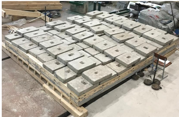
Рисунок 46- Механические испытания пространственной сетчатой деревянной конструкции.
