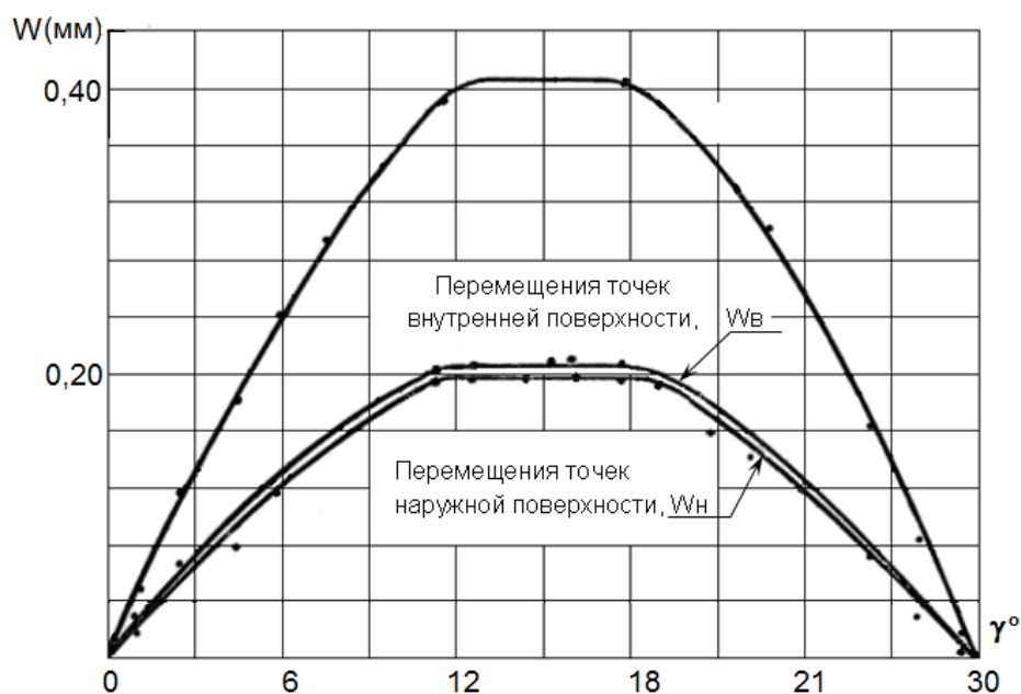
Рис.1 Эпюра перемещений по длине трубки
