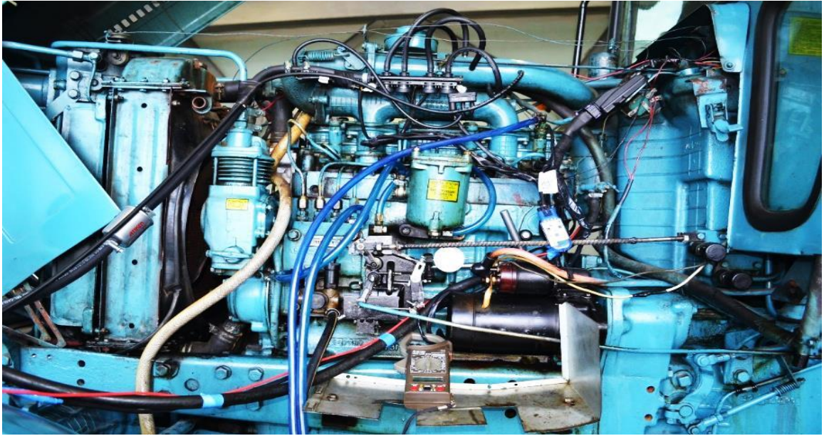
Рисунок 4. Механизм управления запальной дозой.
