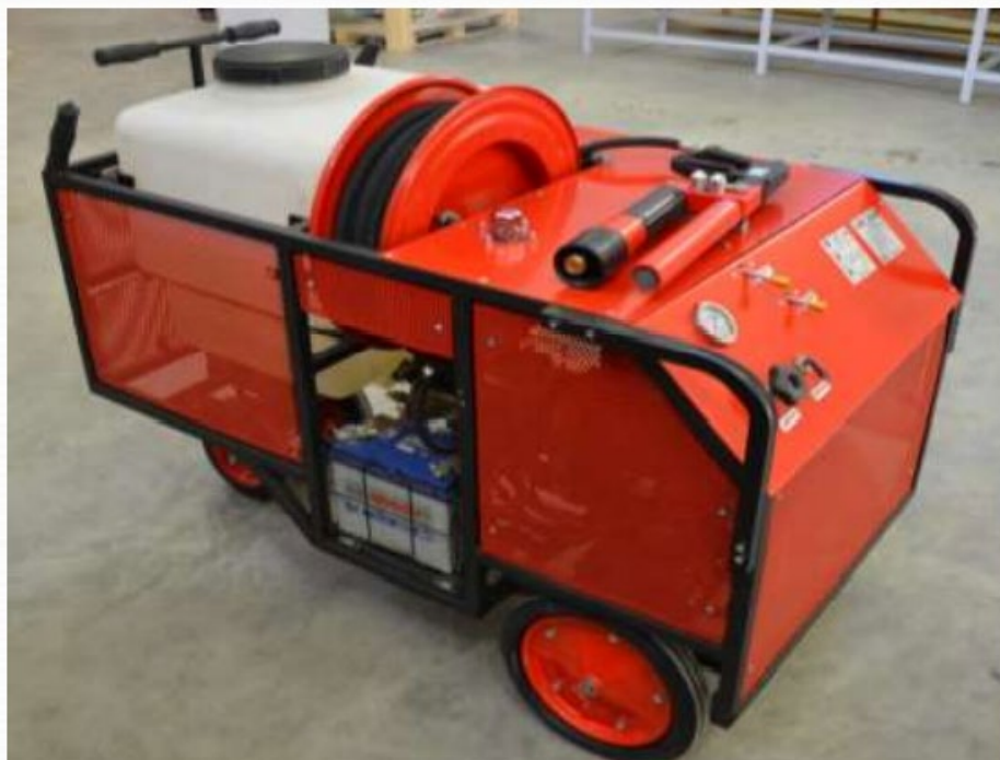
Рисунок 1 – Установка пожаротушения УПТВ 50/50
