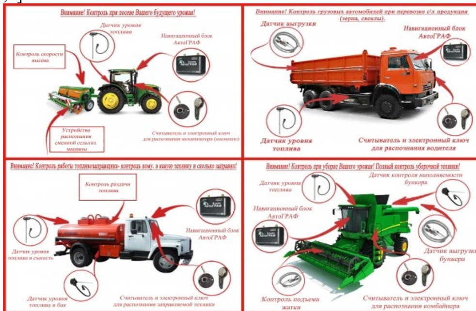
Рис. 2. Схема системы спутникового контроля транспорта и технологических агрегатов «АвтоСкан GPS»
