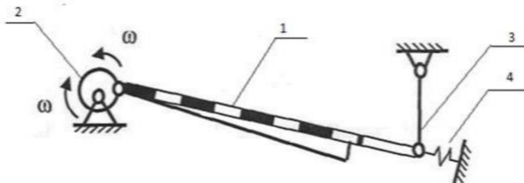
Рис. 2.5 Схема эксцентрикового привода решета: 1 - решето; 2 - эксцентрик; 3 - подвес; 4 - пружина
