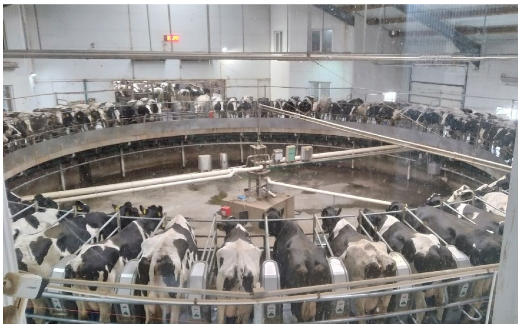
Рисунок 1. Процесс доения на установке «Карусель»
