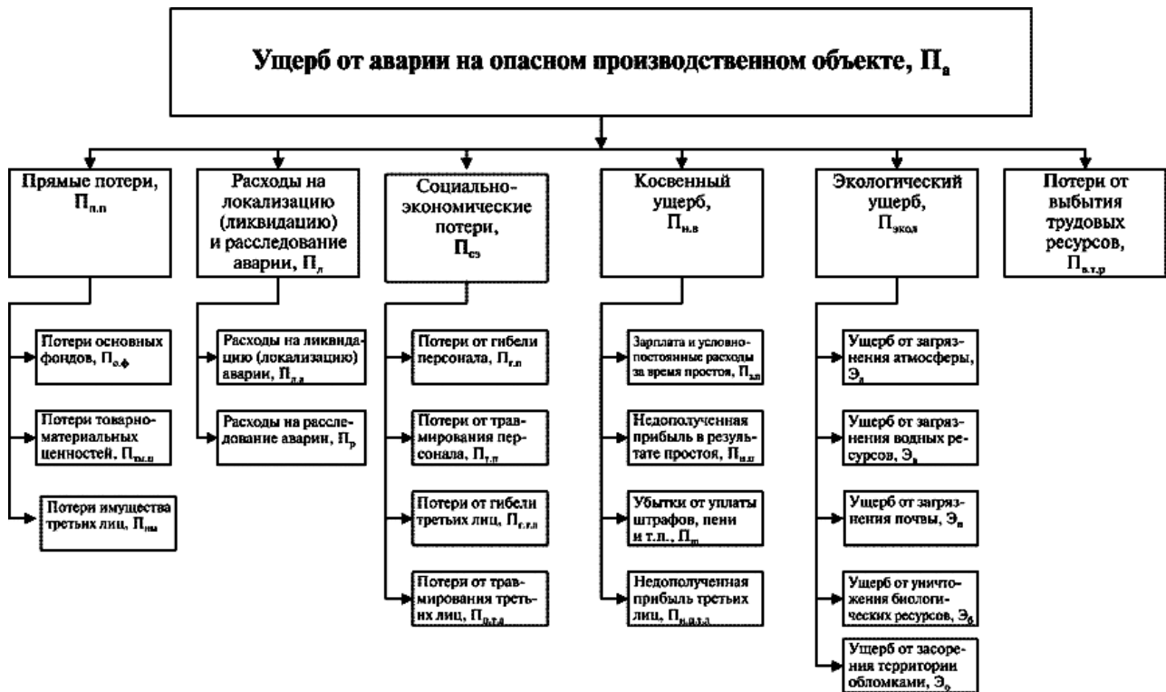
Рисунок 2.4 – Структура оценки ущерба от аварий на опасных производственных объектах
