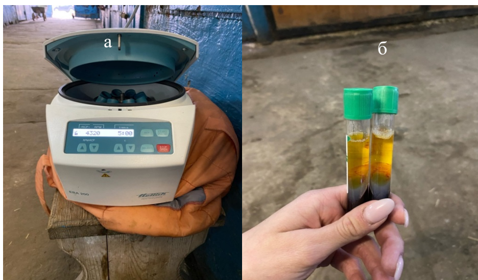
Рис.1. Центрифуга Nettech EVA 200 (а), для разделения веществ по плотности и консистенции; пробирки с готовой плазмой, после центрифугирования (б).
