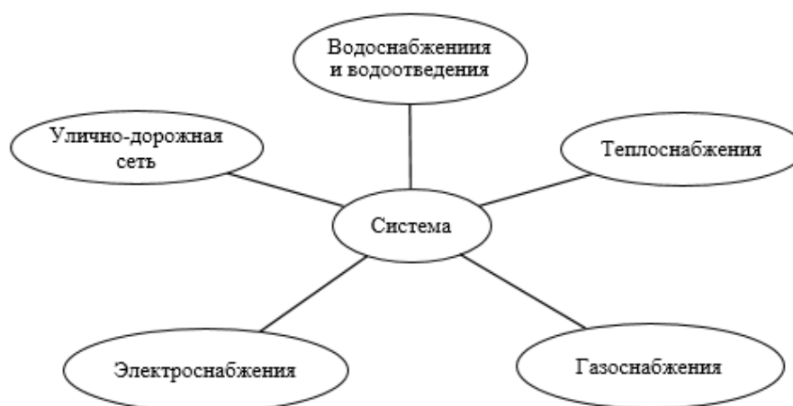
Рис. 1. Система инженерных сетей территории
