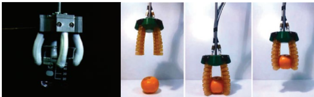
Рисунок. 2. Мягкие захваты самовосстанавливающегося полимера
