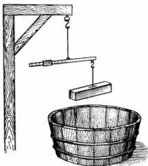
Рисунок 4.2 – Гидростатические весы (простой вариант) для определения объема срубленного дерева (его части)
