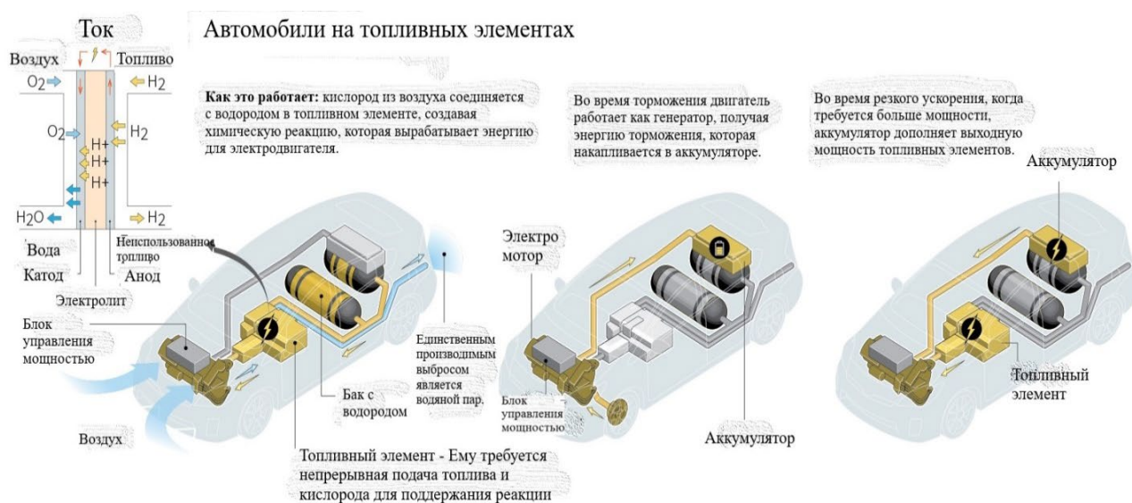
Рисунок 1 – Принцип действия работы электромобиля, гибрида на водородном элементе «ToyotaMirai» [1]
