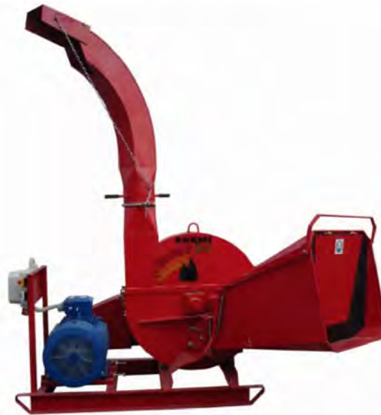
Рисунок 1.13 – Конструктивное исполнение рубительной машины с верхним выбросом щепы
