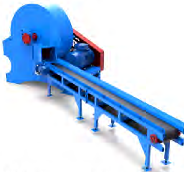
Рисунок 1.14 – Конструктивное исполнение рубительной машины с нижним выбросом щепы
