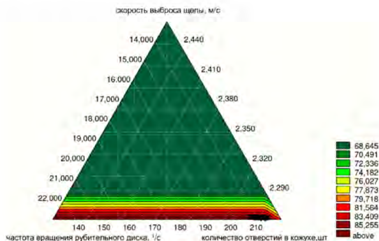
Рисунок 4.1 – Закономерность влияния частоты вращения рубительного диска ( n, 1/c ), количества отверстий в кожухе ( m , шт) и скорости выброса щепы ( v, M/c ) на производительность дисковой рубительной машины ( P , кг/мин)
