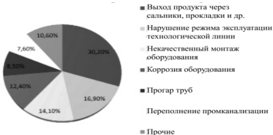
Рисунок 1. Распределение технических причин аварийных ситуаций на открытых промышленных площадках нефтегазовой отрасли.
