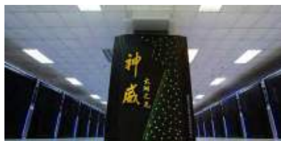
Рис. 4. Sunway TaihuLight - китайский суперкомпьютер, с июня 2016 по июнь 2018 года являлся самым производительным в мире с производительностью 93 петафлопса, согласно тестам LINPACK.
