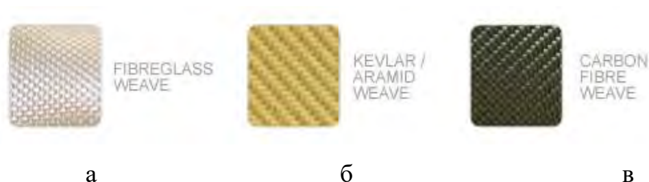
Рисунок 1 – Виды композитных материалов: а – Стекловолокно, б – Кевларовое/ Арамидное волокно, в – Углеродное волокно
