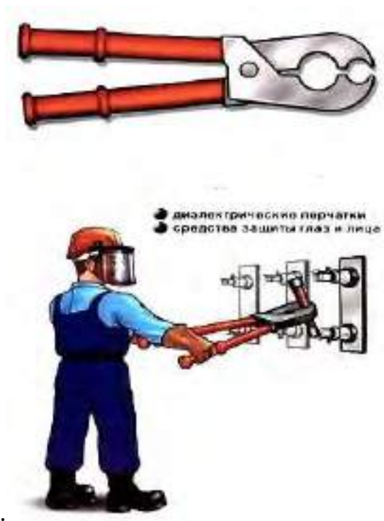
Рис. 2. Замена предохранителя под напряжением.
