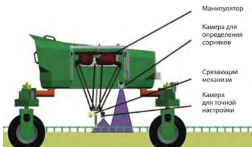
Рис. 3 - Схема робота пропалывателя
