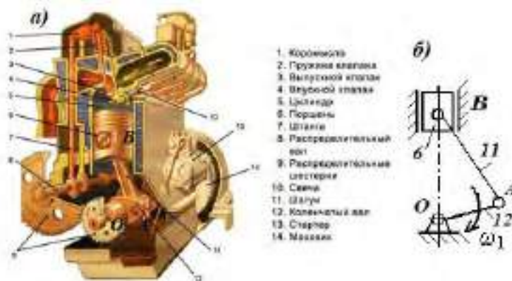
Рис. 4. Механизм ДВС - двигателя внутреннего сгорания (а) и его кинематическая схема (б)
