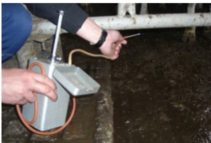
б) Газоанализатор УГ-2
