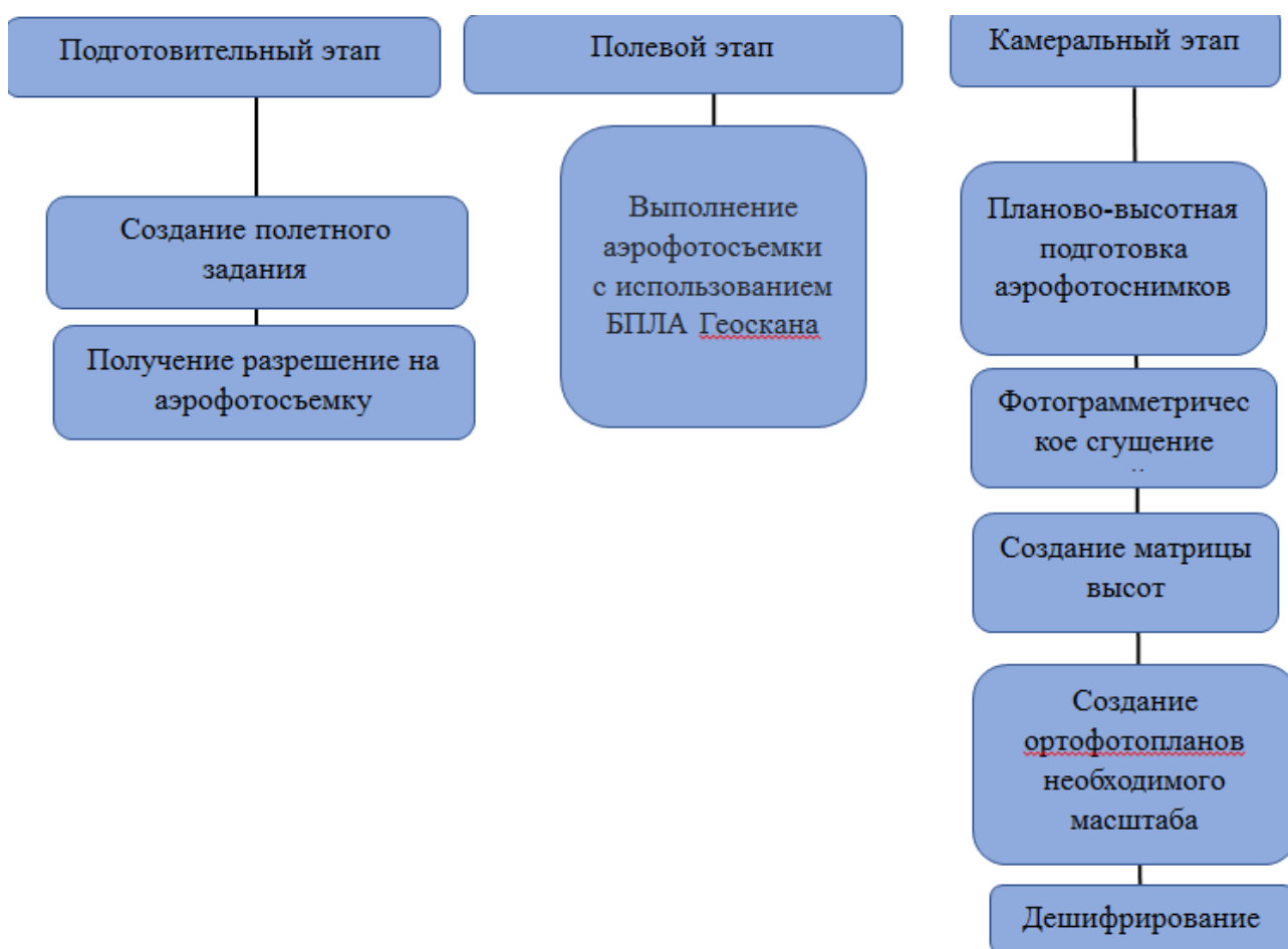
Рисунок 3.1 – Методика производства аэросъемки
