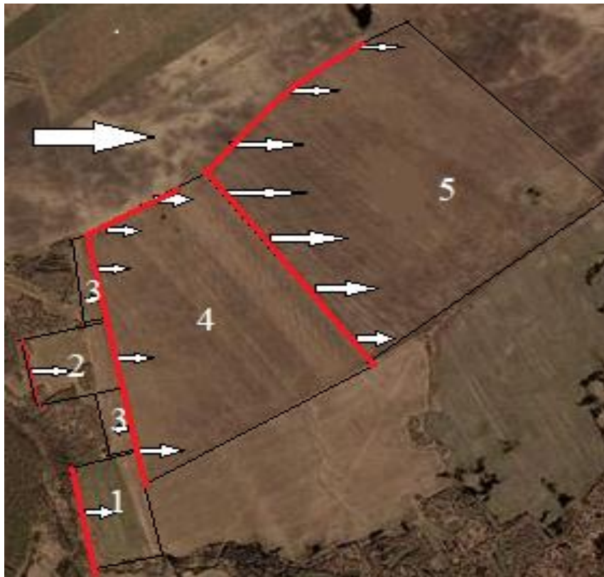
Рис. 9. Схема аэрозольной обработки полей: цифры – номера участков; стрелки – направление ветра и облаков аэрозоля; красная линия – ход генератора в работе
