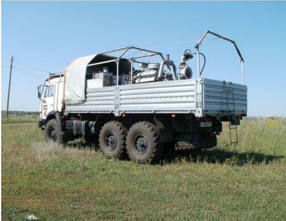
Рис. 2. Генератор аэрозольный «холодного тумана» ГАРД
