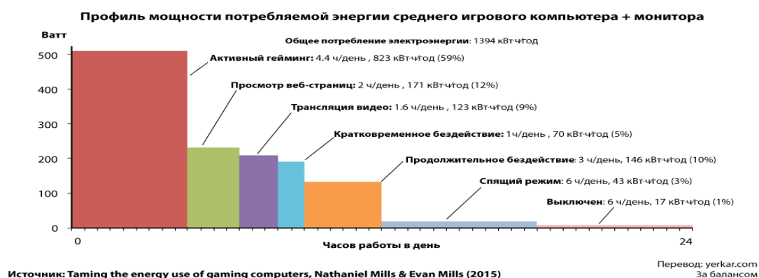
Рисунок 2 – Профиль мощности потребляемой энергии среднего игрового компьютера и монитора
