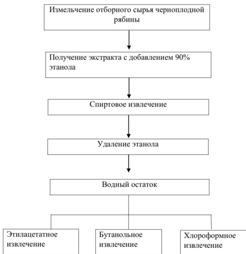
Рисунок 1. Схема получения флавоноидов
