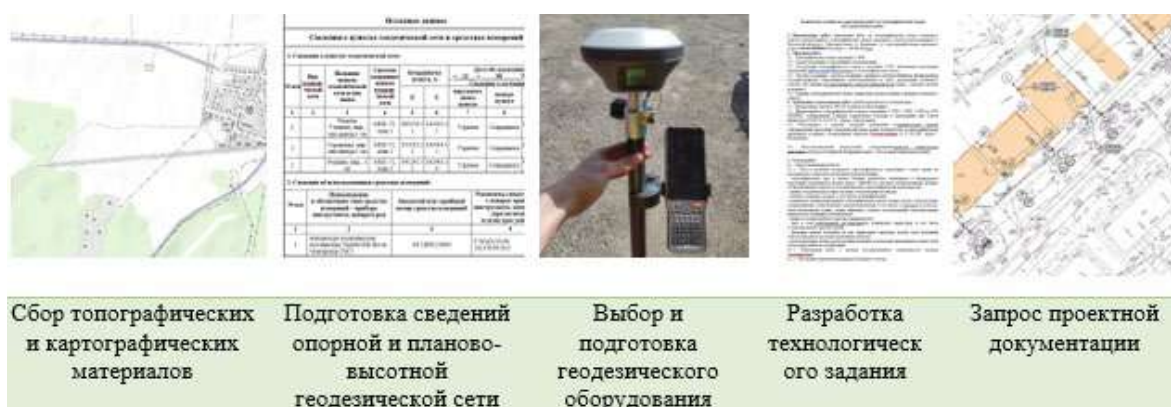
Рис. 1. Виды работ при проведении подготовительного этапа
