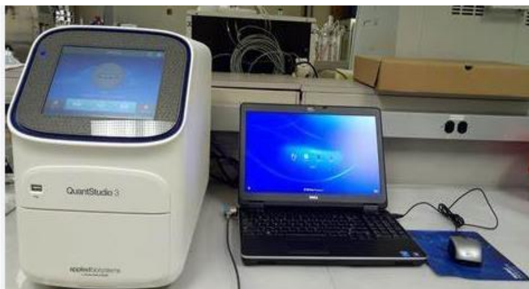
Рисунок 16 - Амплификатор QuantStudio 3.0 Real-Time, используемый для детекции вируса лейкоза крупного рогатого скота
