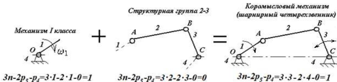
Рис. 2. Картина образования четырёхзвенного коромыслового механизма
