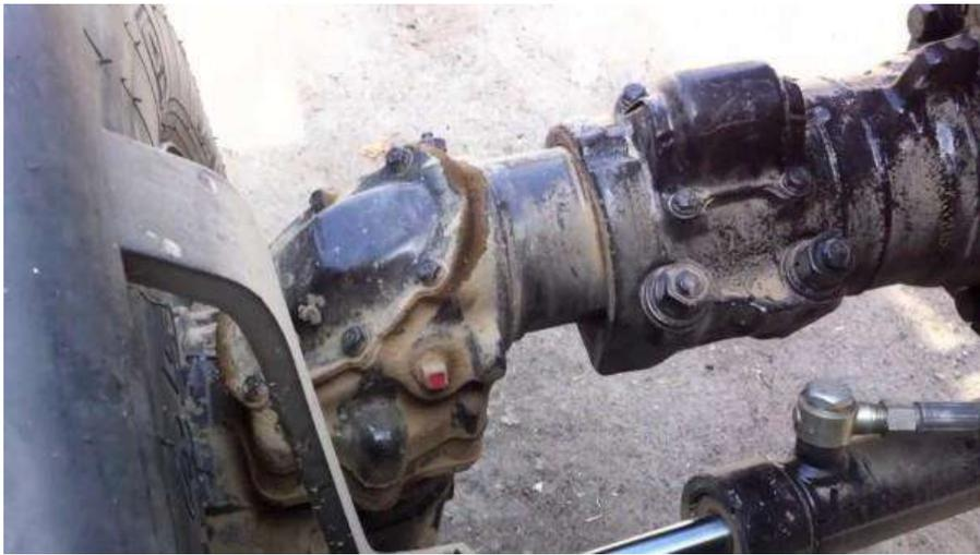
Рис. 1 – Болтовые соединения в эксплуатации
