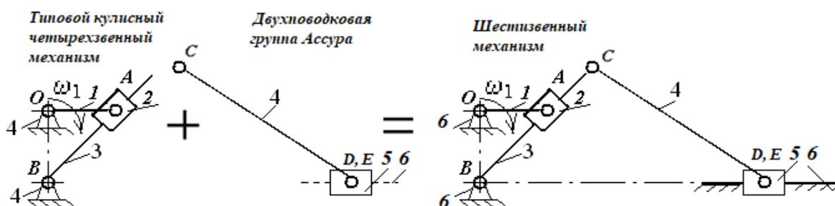
Рис. 5. Образование шестизвенного механизма на основе типового кулисного
