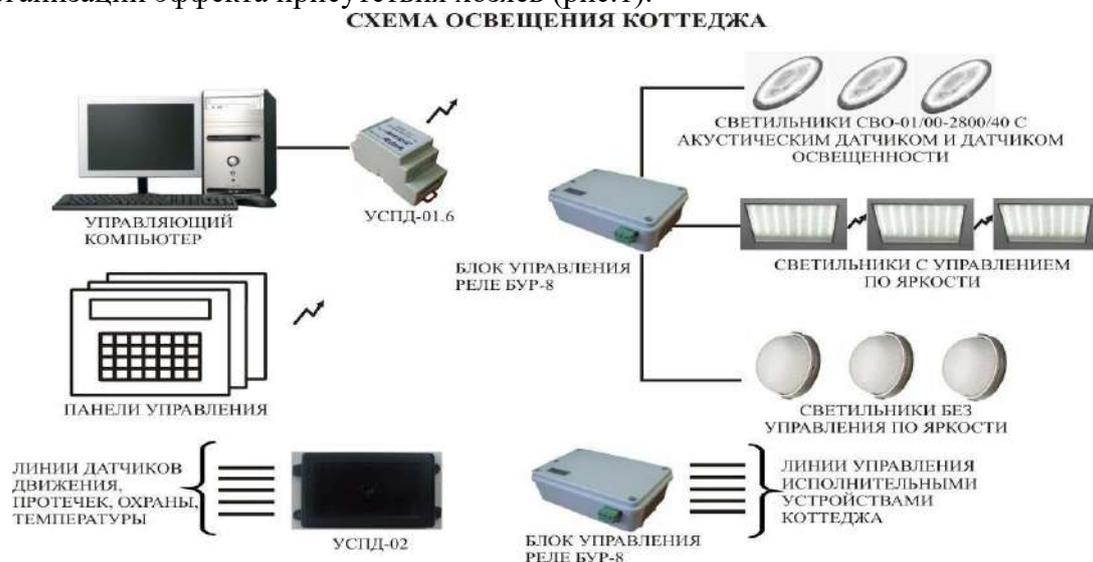
Рисунок 1. - Схема освещения коттеджа
