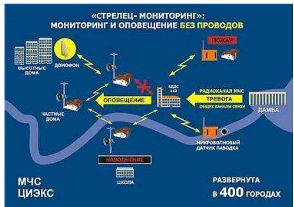
Рис. 29. Работа мониторинга и оповещения
