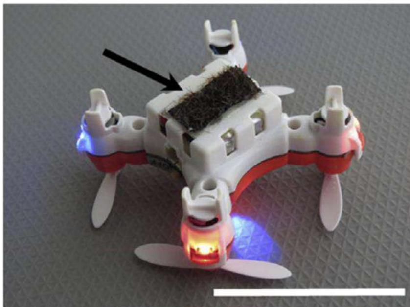
Рис. 2. Дрон опылитель
