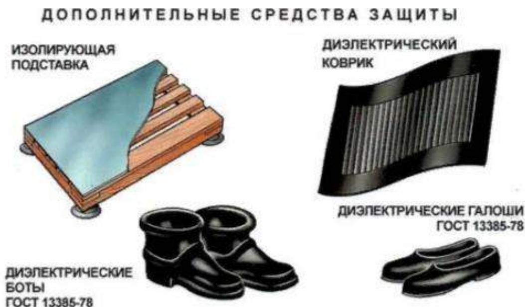
Рисунок 36 - Дополнительные электрозащитные средства
