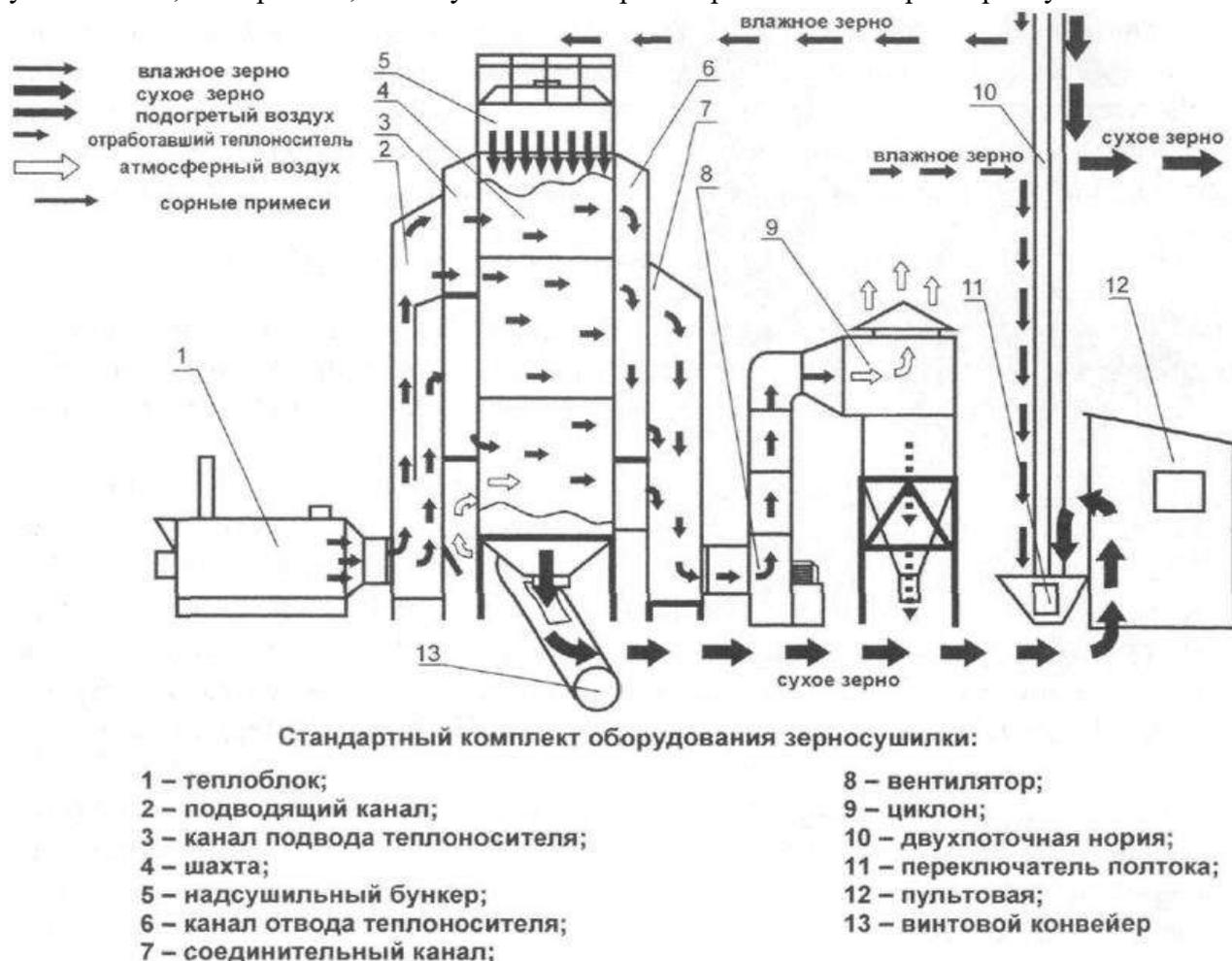
**Рис. 1. Технологическая схема процесса сушки конвективно-кондукторным способом**
