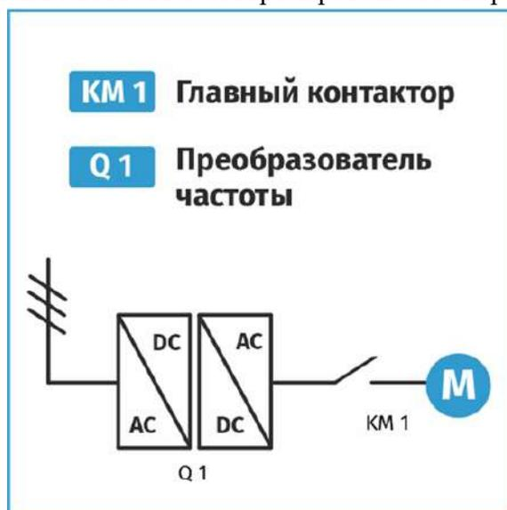
Рисунок 4 - Пуск с помощью преобразователя частоты
