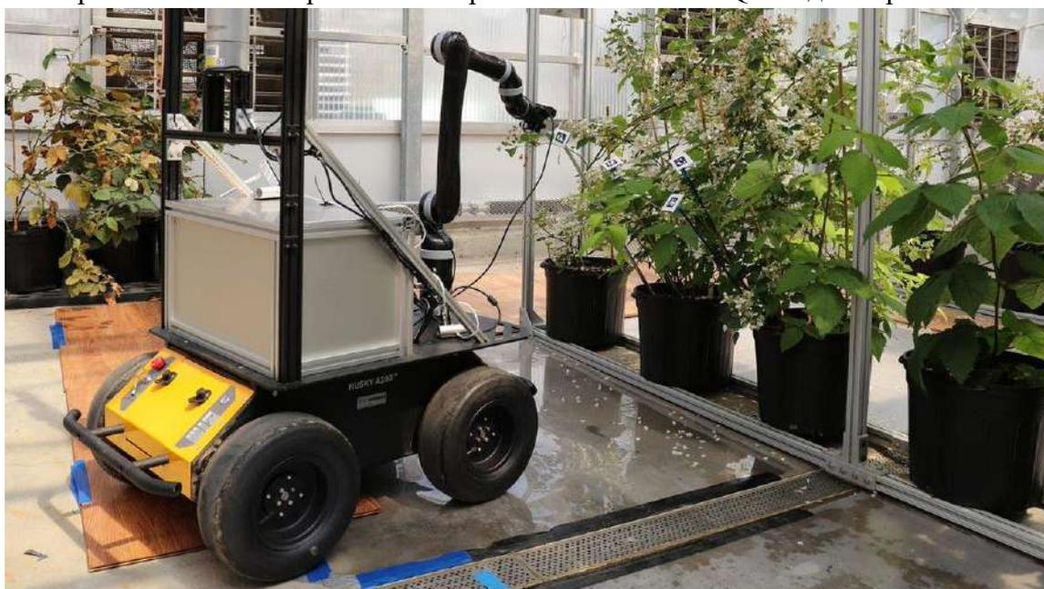
Рис.4. Робот опылитель "BrambleBee"
