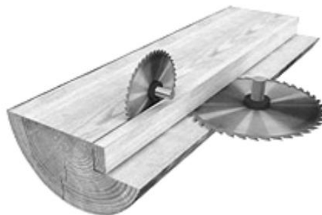
Рисунок 5.6 - Схема распиловки способом углового пиления
