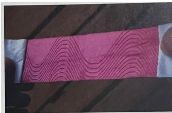
Рис.2. Эта лента непригодна для использования из-за неравномерного, неправильного распределения клея.
