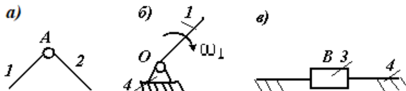
а) соединение двух подвижных звеньев; б) и в) соединение одного подвижного и одного неподвижного звеньев
