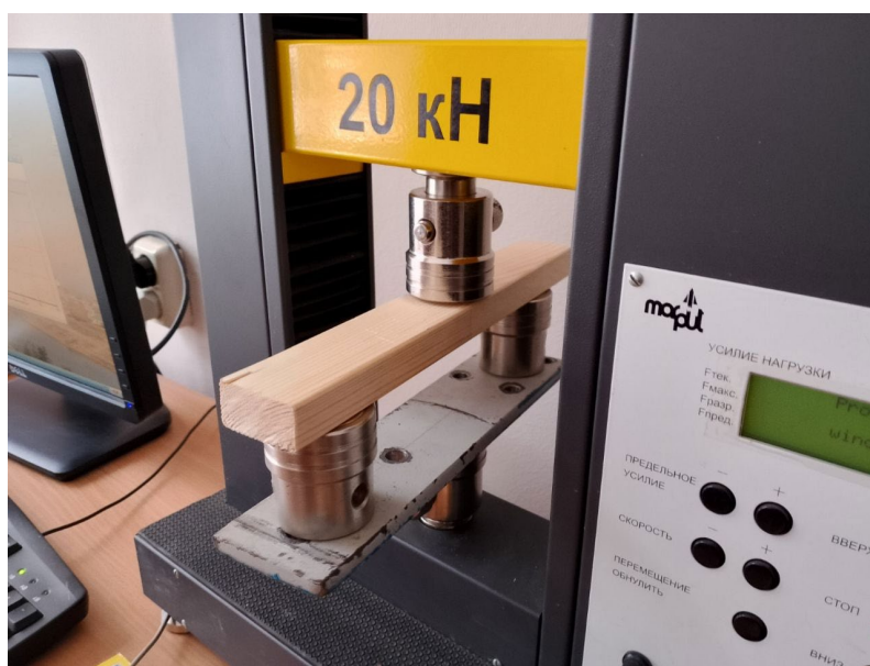
Рисунок 2 Проведение эксперимента на изгиб.
