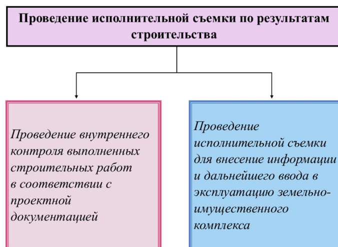
Рис.5. Проведение исполнительной съемки по результатам строительства
