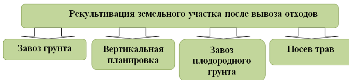
Рис. 4. Этапы рекультивации земельного участка
