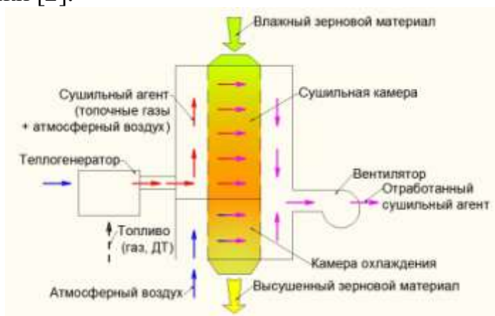
Рисунок 1 – Схема работы современных зерносушилок
