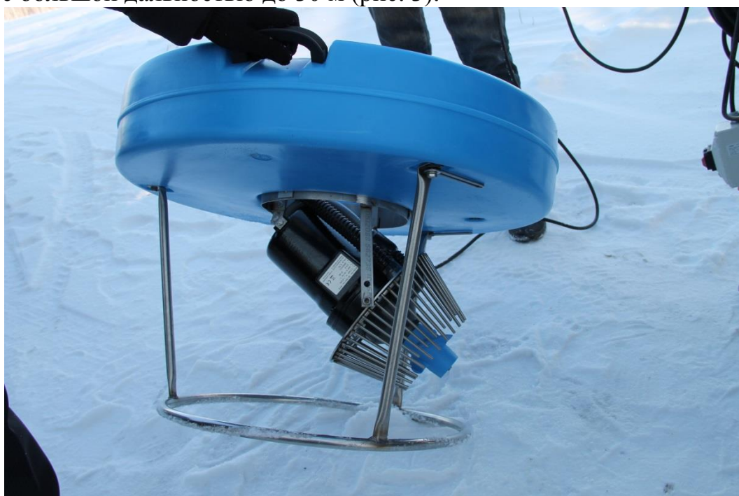
Рис. 3 Аэратор «Turbo-Jet» мощностью 1,1 кВт
