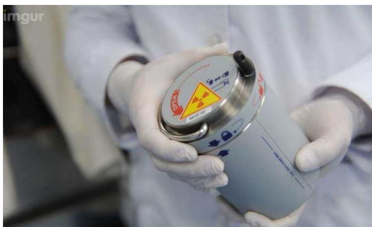
Рисунок 4 - Вольфрамовый контейнер для переноски РФП внутри рабочих помещений. Вес — 14 кг.
